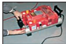
3.- Conectar la manguera al compresor
