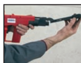
3.- Colocar la guía clavo en la punta del cañon
