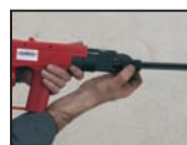
4.- Introducir el clavo hasta el fondo
