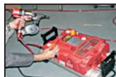
7.- Si la fijación no es correcta volver a regular la presión de trabajo
