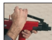
5.- Volver a colocar la guía clavo en su posición original
